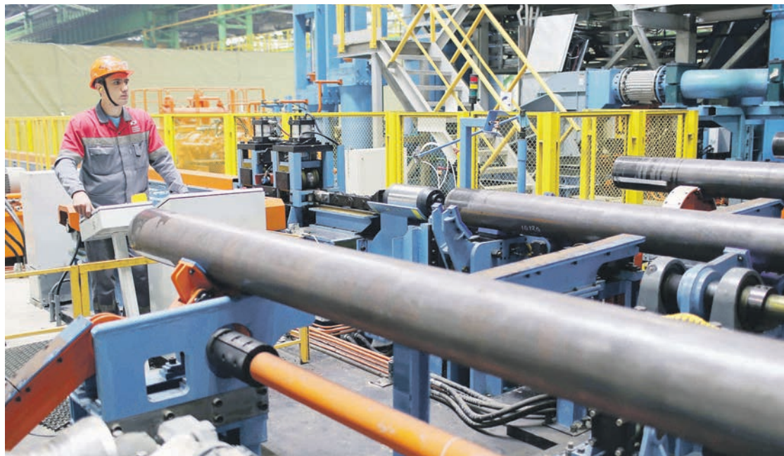
▲ На трубы ТЭСЦ-3 в финишном центре нанесли резьбу и навернули муфты © ВАЛЕРИЙ ПОКУМЕЙКО
